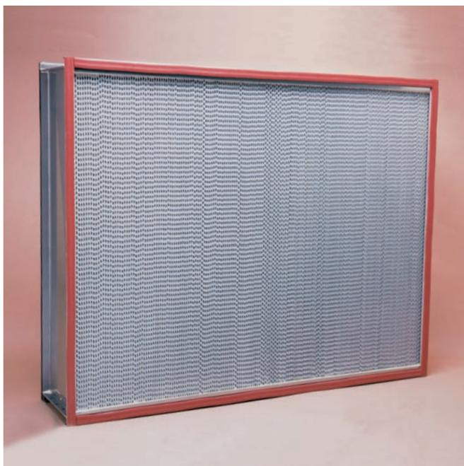
この高温用NS-HL型のエコルターは250℃の高温下においてHEPAフィルターの特性(0.3 $\mu$ mの粒子を99.97%以上捕集)を維持します。
