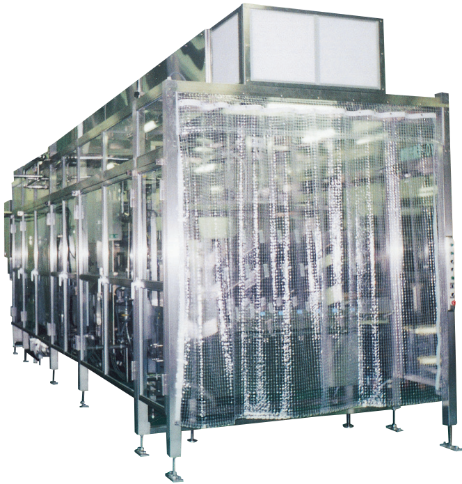
クリーンブース ECB クラス10,000 1.7mW×2.0mL床置型
